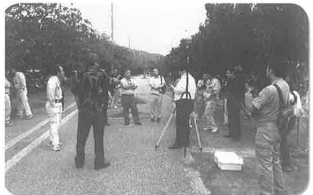
登記基準点等を与点として、スタティック測量により2級の基準点を設置し、それから3・4級を設置する作業は、かなり負担のかかる作業で職員の少ない事務所にとっては大変な作業です。VRSをつかって、登記基準点から3・4級を設置する作
