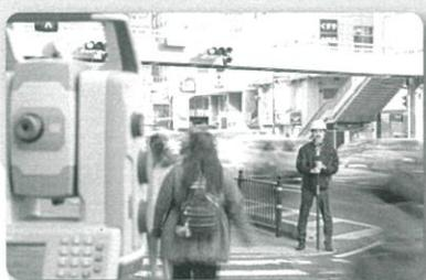
Trimble S シリーズのオートロックは視準精度のまま、ターゲットを常に追い続けます。全ての測量作業で大幅な効率向上とスピードアップを提供します。
