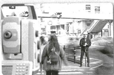
Trimble S シリーズのオートロックは規準精度のまま、ターゲットを常に追い続けます。全ての測量作業で大幅な効率向上とスピードアップを提供します。
